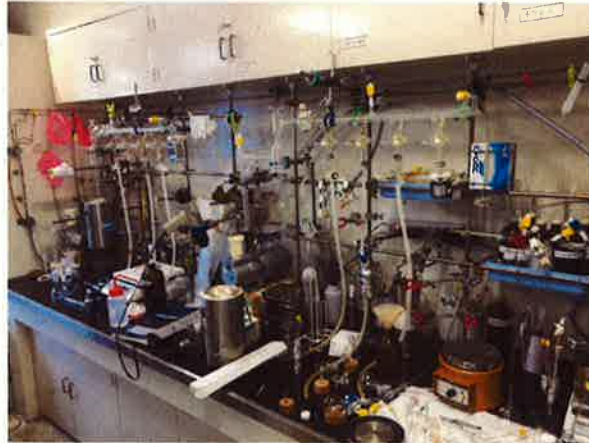
写真1：アルゴン・真空Wマニホールドラインの設置された実験台
