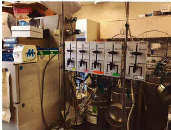
写真2：脱水・脱酸素溶媒供給装置（関東化学）
