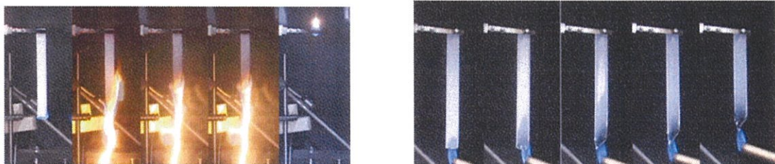
図 1 分子量の異なるポリエチレンのUL燃焼試験 (左：平均分子量 76000、右：平均分子量 35000)
